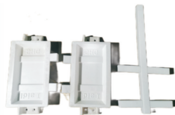
图3 修整完成的白模模样
